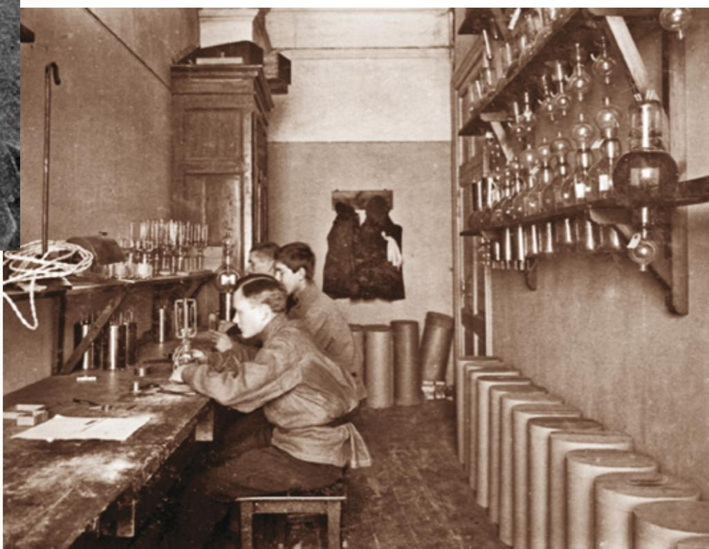
Сборка радиоламп мощностью 1,5 квт с охлаждением проточной водой.
